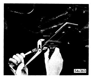
Fig. 11—Tightening Aligning Clip
