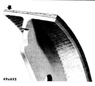
Fig. 12-Brake Lining Edge Wear
