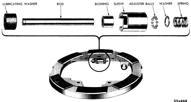
Fig. 42—Automatic Adjuster (Disassembled View)
